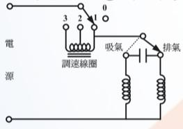
91. (1) 如下圖為果汁機之電路圖，其變速方法採用①無段變速法②多段變速法③改變磁場匝數變速法④調刷變速法。
