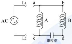
102. (23) 如下圖抽風機馬達是永久電容式，下列敘述何者正確？①正轉時B為行駛繞組②反轉時A為啟動繞組③A繞組與B繞組線圈粗細一樣④A繞組與B繞組線圈粗細不一樣。
